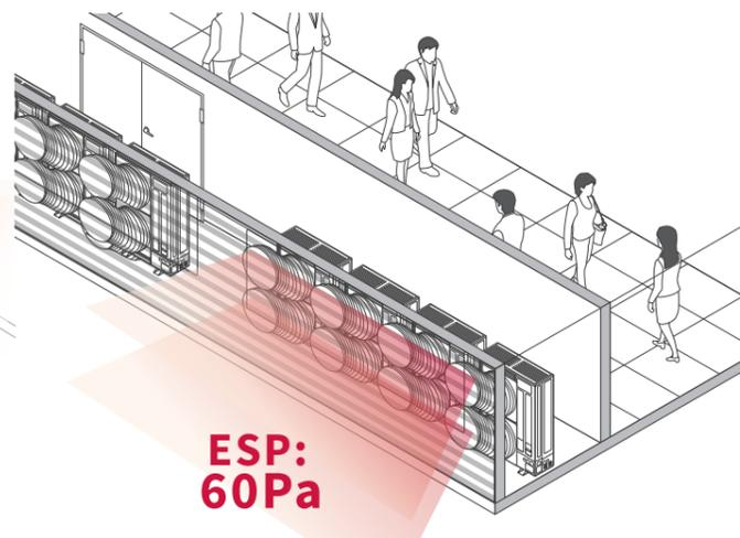
Nota: el predeterminado de fábrica es 0 Pa, se puede seleccionar presión estática externa adicional (30 Pa o 60 Pa) mediante el ajuste del interruptor DSW!
