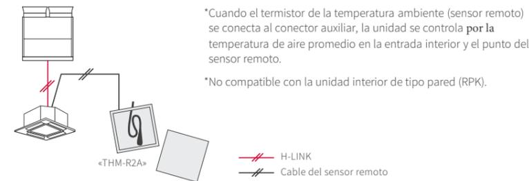
\*Cuando el termistor de la temperatura ambiente (sensor remoto) se conecta al conector auxiliar, la unidad se controla por la temperatura de aire promedio en la entrada interior y el punto del sensor remoto.
